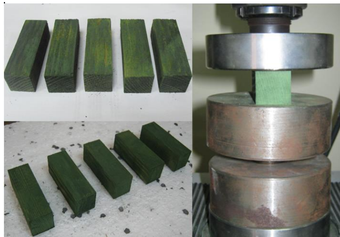
Şekil 9. Krom oksit nano Parçacık emprenye edilmiş dik basınç deney düzeneği ve numuneleri
